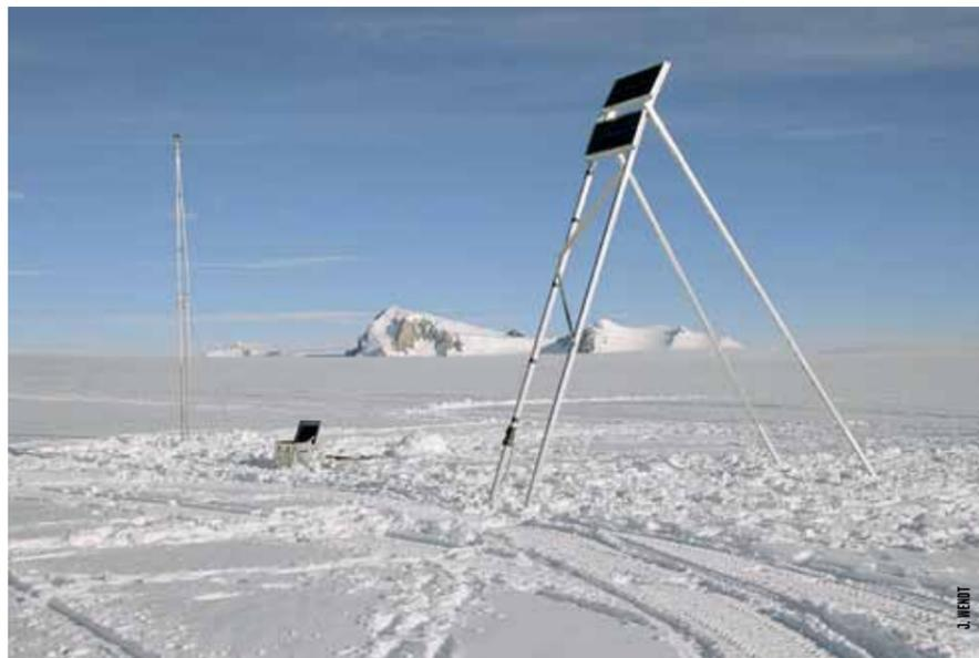
Figura 4. Foto de la estación de GPS continuo que se instaló en el glaciar Fleming en diciembre de 2008 y que operó hasta su retiro en octubre de 2009.
