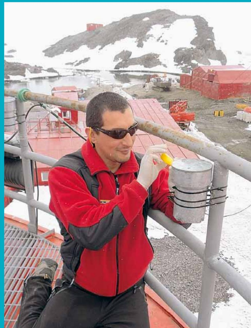
Figura 1. Desplegando muestreadores pasivos de aire para determinar COPs en la base O'Higgins, península Antártica (enero de 2010).
