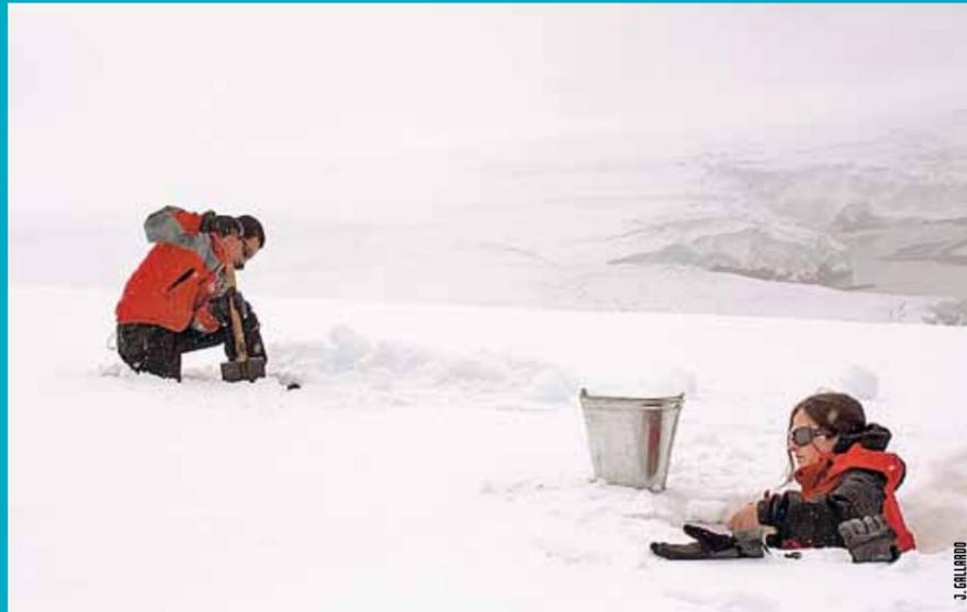
Figura 2. Tomando muestras de nieve en el glaciar Collins para determinar la acumulación temporal de COPs en ese compartimento ambiental.
